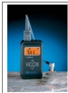
Рис. 4 Толщиномер T-Mike B (США) позволяет выбрать один из пяти заранее заданных материалов (сталь, алюминий, оргстекло, нержавеющая сталь, чугун)
