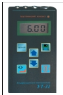
Рис. 3 Толщиномер УТ-31 (Украина) обладает регулируемым усилением, что позволяет отстроиться от ложного срабатывания на неоднородностях в материале
