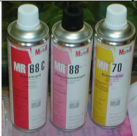
Рис. 4. Набор дефектоскопических материалов в аэрозольных баллонах
