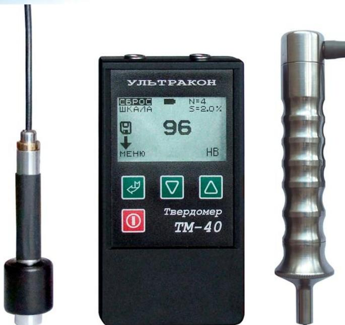
Легкий, малогабаритный, универсальный твердомер с высокой производительностью и простотой проведения измерений, а также высокой степенью пылевлагозащиты (IP54).
