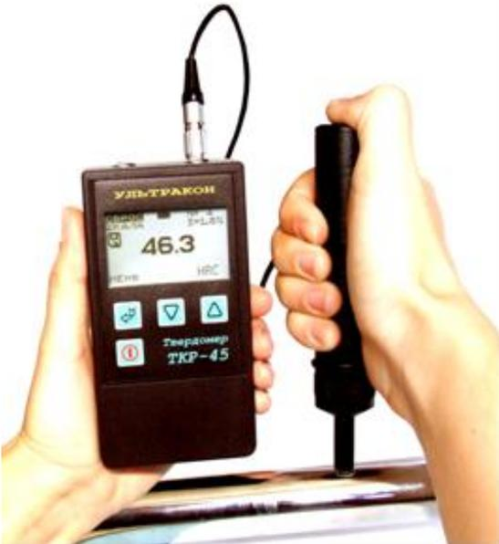
Твердомер использует импедансный ультразвуковой метод измерения (UCI), который основан на измерении относительных изменений механического импеданса колебательной системы преобразователя в зависимости от механических свойств поверхности образца.
