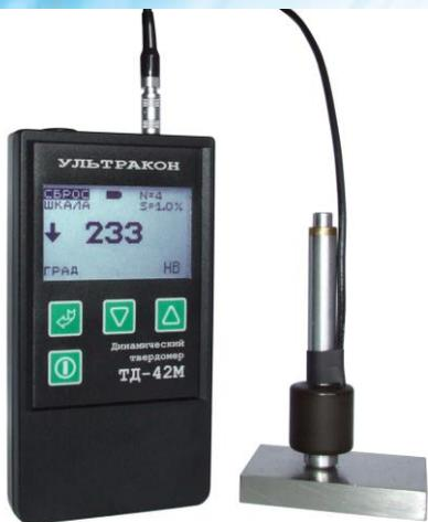
Легкий **бюджетный** прибор с высокой производительностью и простой проведения измерений, а также высокой степенью пылевлагозащиты (IP54). Предназначен для оперативного **измерения твердости** промышленных изделий динамическим методом по шкалам **Бринелля, Роквелла и Виккерса**, а также **пересчета в предел прочности** по ГОСТ 22761-77 и диагностики остаточного ресурса металла во всех отраслях промышленности, в производственных и лабораторных условиях.
